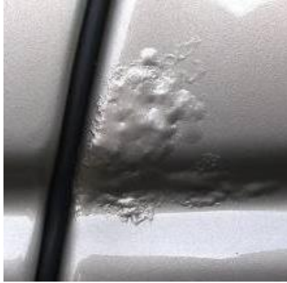
6xxxシリーズ塗装シートアルミニウムの糸状腐食
