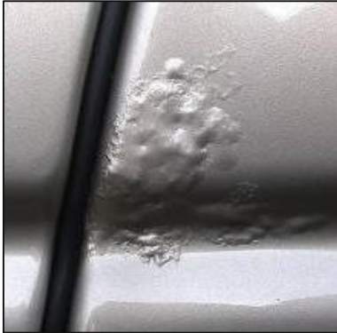
Corrosión filiforme en chapa de aluminio pintada serie 6xxx.
