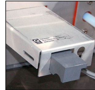
Kombisensor Feuchte + Kammertemperatur
