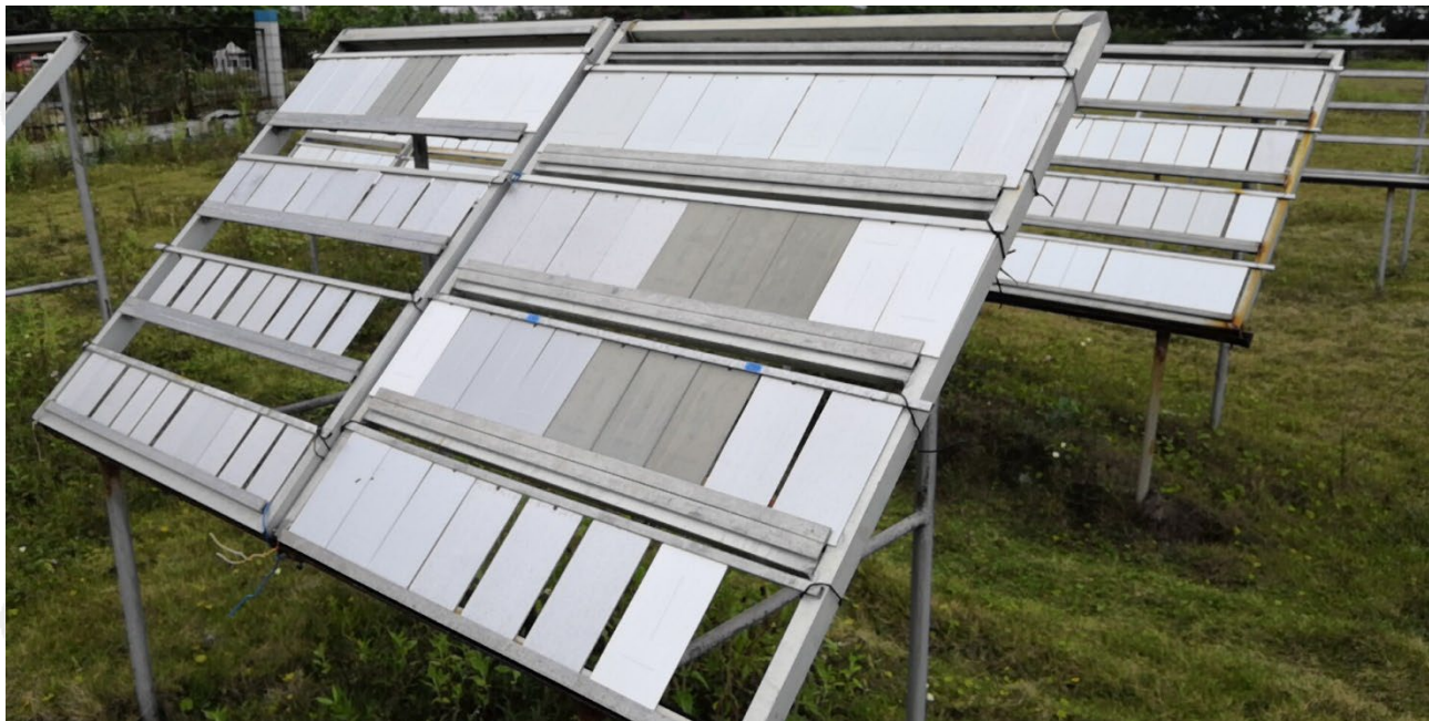
Spray salt water 人工喷洒盐水
