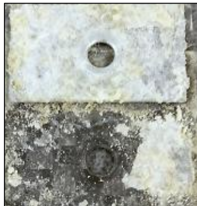
カーボンファイバーと接触した 5000系のアルミニウム
