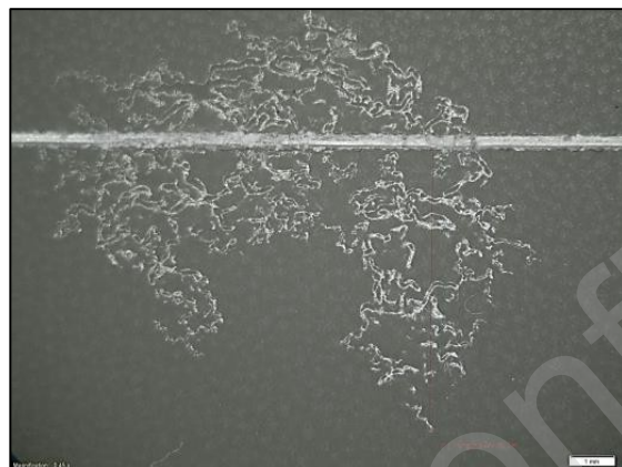
6000系塗装シート状 アルミニウムの糸状腐食
