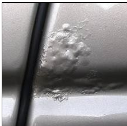
6000系塗装シート状 アルミニウムの糸状腐食
