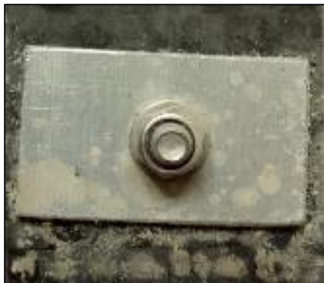
カーボンファイバーと接触した 5000系のアルミニウム
