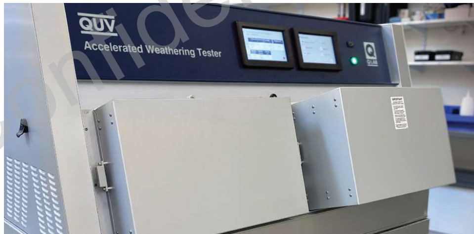
QUV门已拆除并安装3D箱
