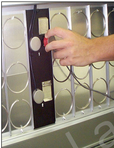
将传感器安装在校准端口中
