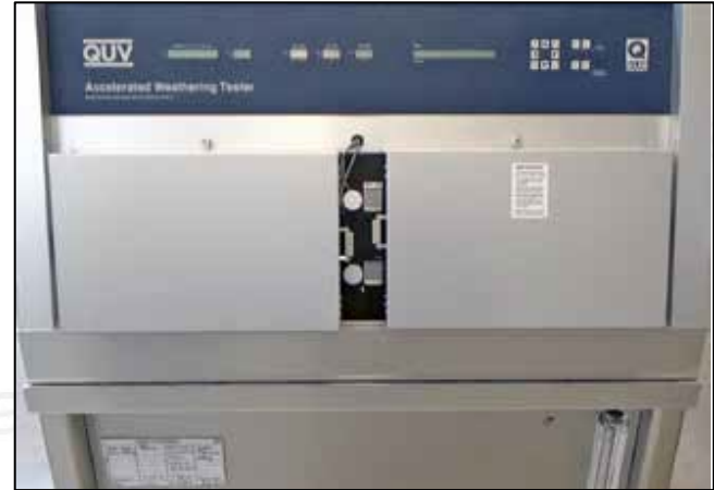
QUV với bộ gá 3D chuyên dụng (tháo cửa buồng)
