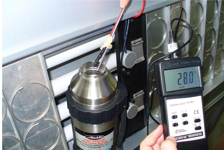
Schritt 2: Befestigen Sie den Sensor an der Referenz und tauchen Sie ihn in einen isolierten Behälter
