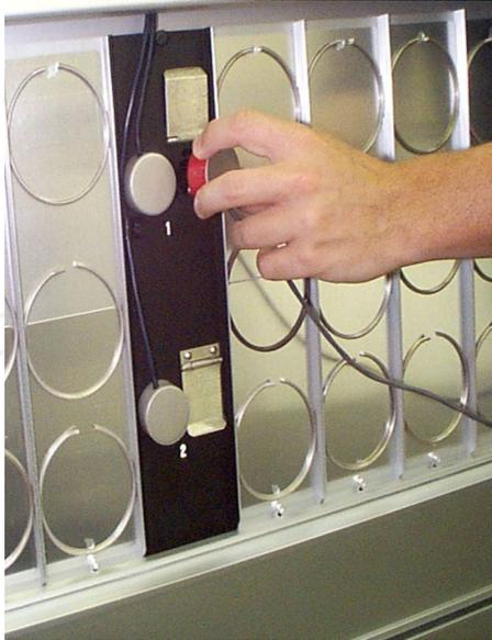
Montieren Sie den Sensor im Kalibrierungsanschluss
